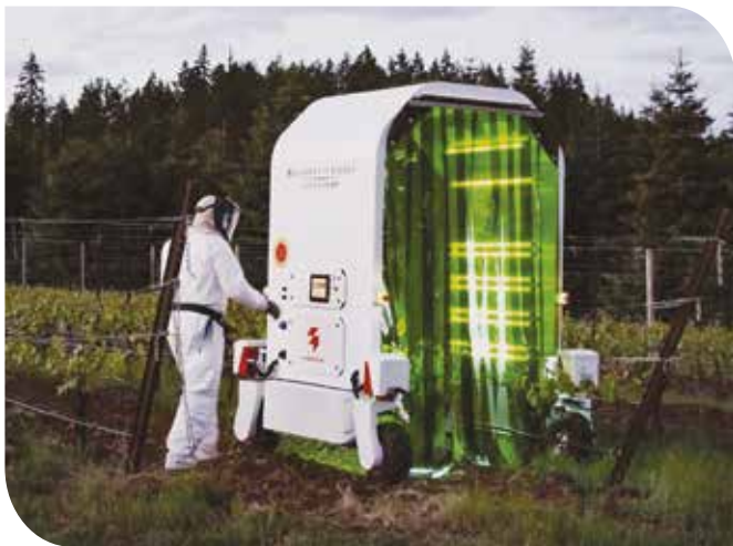
→ 1. KÉP: A LISZTHARMAT ELLENI KORSZERŰ VÉDEKEZÉSI ELJÁRÁS, ÖNJÁRÓ ALAGUTAS UV-FÉNYES (SAGA ROBOTICS) KÉSZÜLÉK
