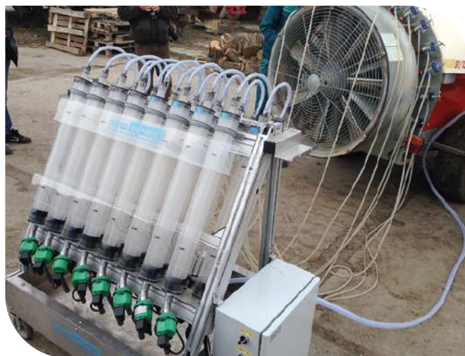
→ 2. KÉP: ÜLTETVÉNYEKBE GYAKRAN HASZNÁLT AXIÁLVENTILÁTOROS PERMETEZŐGÉP MŰSZAKI FELÜLVIZSGÁLATOKOR A SZÓRÓFEJEK FOLYADÉKADAGOLÁSÁT ÜZEMI NYOMÁSON MÉRŐ SPECIÁLIS KÉSZÜLÉK
