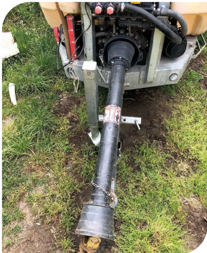
→ 1. KÉP: A PERMETEZŐGÉP BIZTONSÁGI BERENDEZÉSEINEK MEGLÉTÉT (PL. KARDÁNBURKOLAT) IS ELLENŐRZIK
