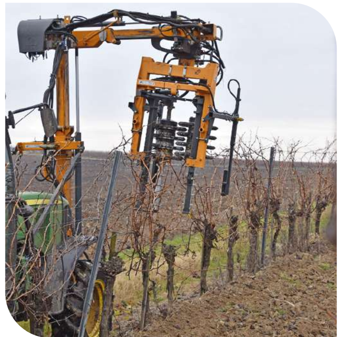
→ 4. KÉP: AZ EDECK KFT. SZÁLVESSZÓS METSZÉSŰ ÜLTETVÉNYEIBEN AZ ELŐMETSZŐ GÉP A FELSŐ HAJTÁSTARTÓ HUZALPÁR MENTÉN VÁGJA EL A VENYIGÉT, ÍGY A MEGMARADT VESSZŐKBŐL MÉG MEGFELELŐEN KIALAKÍTHATÓ AZ IDEI HOSSZÚ METSZÉSI ELEM.
