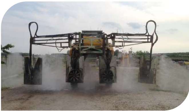
→ 3. KÉP: PERMETEZŐGÉP VÍZZEL TESZTELÉSE AZ ESETLEGES HIBÁK KIKÜSZÖBÖLÉSÉÉRT
