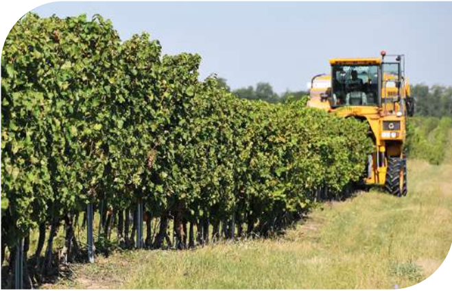
→ 3. KÉP: GÉPI SZÜRET AZ EDECK KFT. ÜLTETVÉNYÉBEN. A GÉPESÍTÉS LEGFONTOSABB FELTÉTELE A TÁMBERENDEZÉS KIFOGÁSTALAN ÁLLAPOTA ÉS AZ ALKALMAS SZŐLŐFAJTA.
